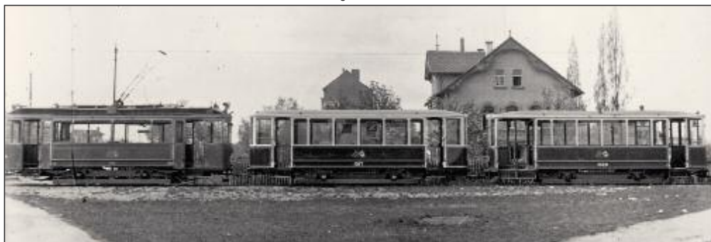
Während die erste Serie 1001 - 1021 nur Einfachtüren besaß, wurde ab der Wagennummer 1022 jeweils eine Tür je Plattform doppelt ausgeführt, wie dieser Zug in Muggenhof zeigt.
